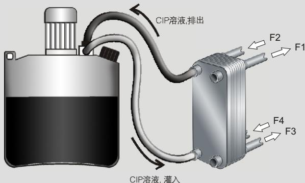
BPHEs中的流体通常来说紊流程度高，这意味着通道可以自清洗。但是，在某些应用领域中，结垢的可能性很高，如在高温下使用硬度极高的水时。在此情况下，通常可通过清洗液循环流动（CIP---就地清洗）对换热器进行清洗。使用一个装有弱酸的容器（如5%的磷酸，如果换热器经常进行清洗，则使用5%的草酸）。泵送清洗液通过整个换热器。
