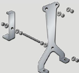
当您需要对我们的换热器进行机械支撑时，我们可提供专门定制的脚支架和墙壁安装成套零件。每套零件都具有合适的尺寸，并配有齐全的固定件，在现场可立即安装。为了快速、方便的组装，并保证一次安装成功，我们的支架装备不能损坏。
